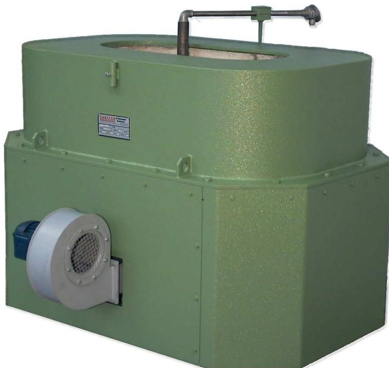
Forni trifase a frequenza di rete mono bacino ovale adatti alla fusione del bronzo e bronzo alluminio. Questo tipo di forno è indicato per l'utilizzo in pressofusione (camera fredda) e per fusioni a gravità con prelievo manuale del metallo.
