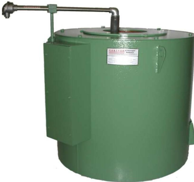
La nostra produzione comprende forni a resistenze per fusione di alluminio e zama di tutte le potenze e misure per i crogioli normalmente in commercio. Da Kg. 35 a Kg. 630
